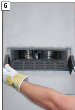
6 Sichtschutzblende schräg angestellt in die Konvektionsluftöffnung einstecken und dann bis zum Anschlag nach unten schieben.
