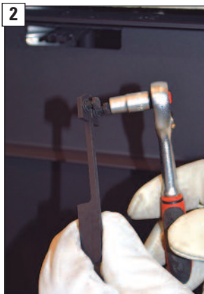
Befestigungsschrauben zur Montage soweit als möglich herausschrauben.
